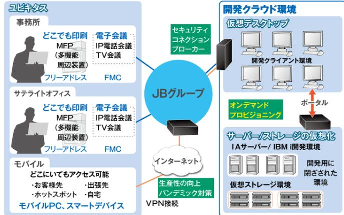
※FMC (Fixed Mobile Convergence) 移動体通信と有線通信を融合した通信サービスの形態。
